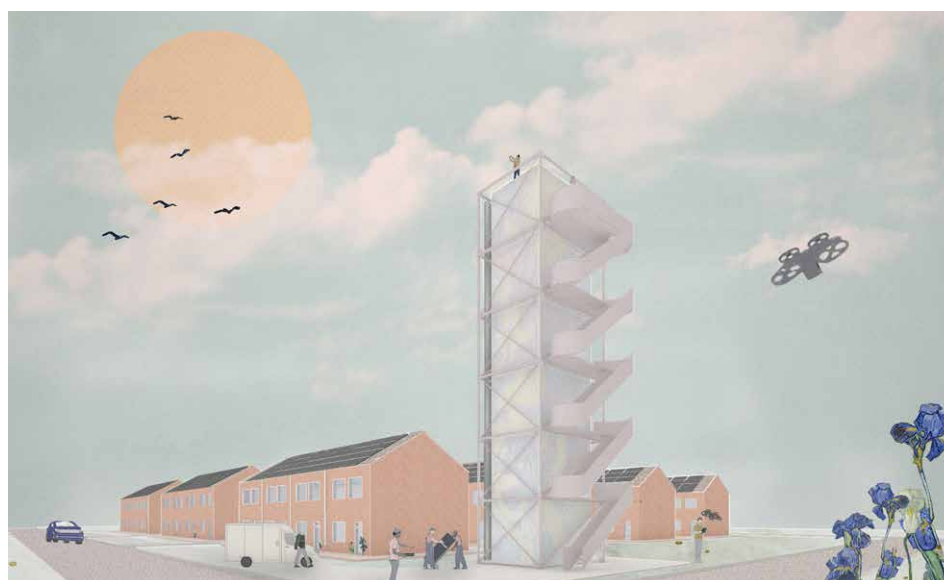
De 'Teams-toren' kan worden toegepast in woonwijken. In server-verdiepingen wordt de data uit de buurt opgeslagen en restwarmte kan de omliggende woningen verwarmen. De toren speelt ook een rol in balans tussen vraag en aanbod van duurzame elektriciteit in de buurt, in combinatie met elektrische auto's en buurtbatterijen.
